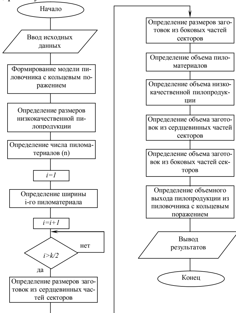
Рисунок 3 – Укрупненная блок-схема определения объемного выхода пилопродукции из пиловочника с кольцевым поражением
